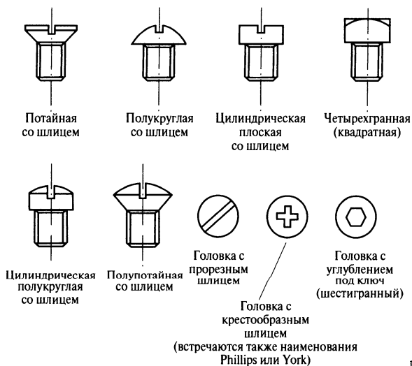
Рис. 59. Варианты головок винтов
