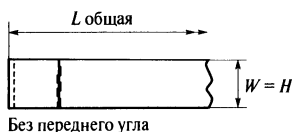
Рис. 120. Расточный резец, или резец для обработки под углом
